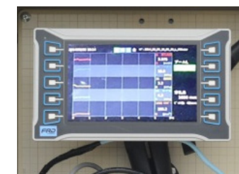
全断面せん孔実績記録装置 前方探査記録装置
