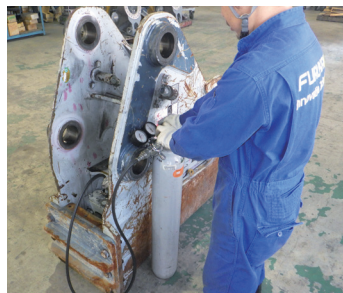
窒素ガス封入圧力の管理
