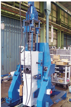
専用治具による油圧ブレーカの分解・組立
