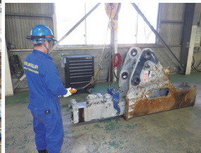
専用治具による油圧ブレーカの分解・組立
