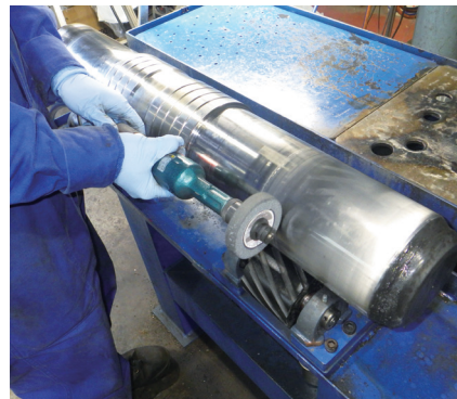
回転砥石によるピストンの研磨加修
