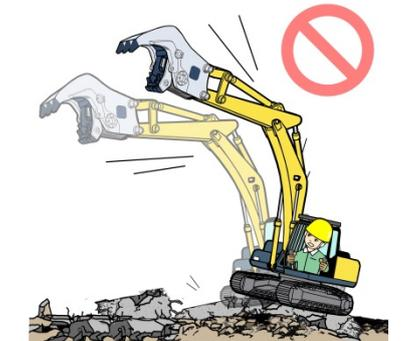
不安定な場所での作業は危険です。作業現場や走路は平坦に整地してください。建物内での作業は床の強度を点検し、十分安全であることを確認し、床の崩落に注意が必要です。
