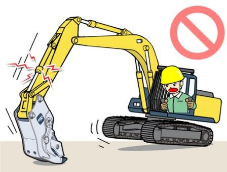
圧砕機を押付けてジャッキアップしての方向転換は、無理な力が発生し双方の故障や事故を引き起こすことがあります。
