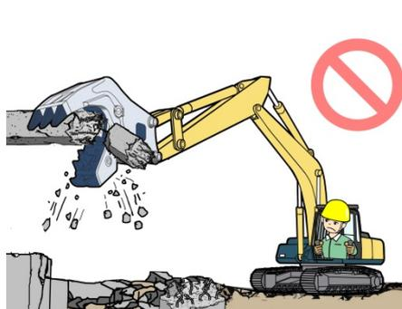
カッター刃でコンクリートの破砕作業をしないでください。カッター刃が摩耗し、鉄筋が切れなくなります。
