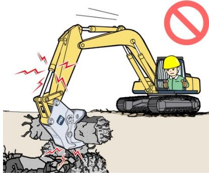
油圧シリンダがストロークエンドの状態では思わぬ外部の力でロッドの曲りやロッドの抜け、リンクの曲りなどの破損事故につながります。
