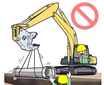
圧砕機によるクレーン作業は禁止です。圧砕機のフックは、圧砕機本体の運搬・積込み用ですので使用禁止です。
