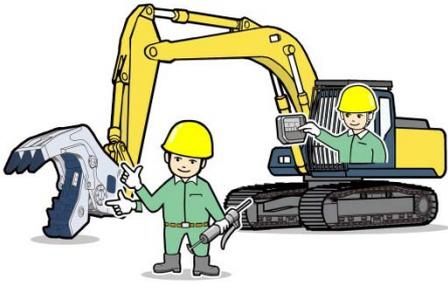
作業の開始前および終了後には、必ず各部点検を行う。(油漏れ、ボルトのゆるみ、油圧ホースの傷、各部へのグリスアップなど) 作業中は2時間ごとにグリスアップ。
