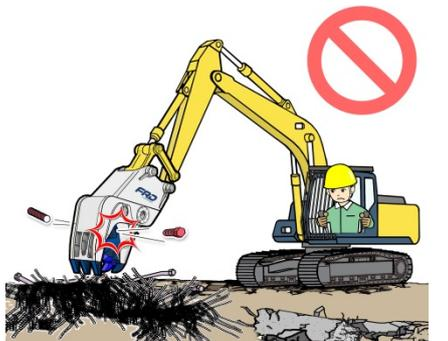
焼入れボルト、ステンレス、ワイヤー、高張力鋼板など、熱処理した材料は切断しないでください。
