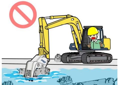
水中での作業は、圧砕機および油圧ショベルの重大な故障につながります。
