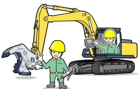
作業の開始前および終了後には、必ず各部点検を行う。（油漏れ、ボルトのゆるみ、油圧ホースの傷、各部へのグリスアップなど）
