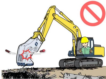
焼入れボルト、ステンレス、ワイヤー、高張力鋼板など、熱処理した材料は切斷しないでください。
