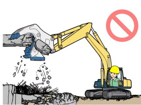
カッター刃でコンクリートの破碎作業をしないでください。カッター刃が摩耗し、鉄筋が切れなくなります。
