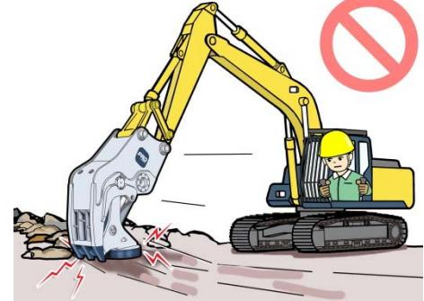
圧碎機本体によるならし作業は、圧碎機および油圧ショベルの故障につながります。
