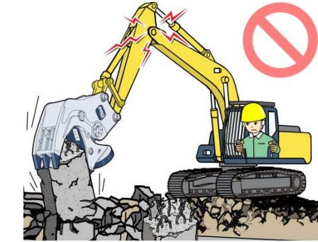
小割圧碎機で基礎解体は行わないこと。噛む力で油圧ショベルや圧碎機の破損事故を引き起こします。
