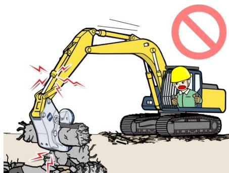
油圧シリンダがストロークエンドの状態では思わず外部の力でロッドの曲りやロッドの抜け、リンクの曲りなどの破損事故につながります。
