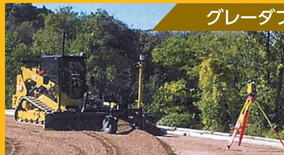
レーザ、トータルステーション、GNSSに対応。最新のテクノロジーで、敷均しや整地作業を“賢く”アシスト。
